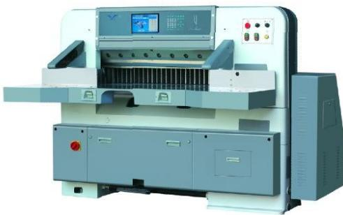
Aceasta masina este un model deosebit, cu structura ferma, cu taieri cu buna acuratete si foarte sigure. Este dotata cu ambreiaj electromagnetic. Presa este actionata hidraulic si poate fi reglata functie de necesitati. Masa ghitotenei este dotata cu duze de aer pentru a usura deplasarea hartiei.
